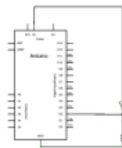
Heureusement pour nous, la plupart des microprocesseurs comme l'ATMEGA328 sur lequel est basé la UNO possède un pull-up intégré. Mettre une entrée en mode pull-up nous permet de faire le montage suivant, qui est nettement plus pratique et évite une résistance, pour brancher par exemple un bouton poussoir.
