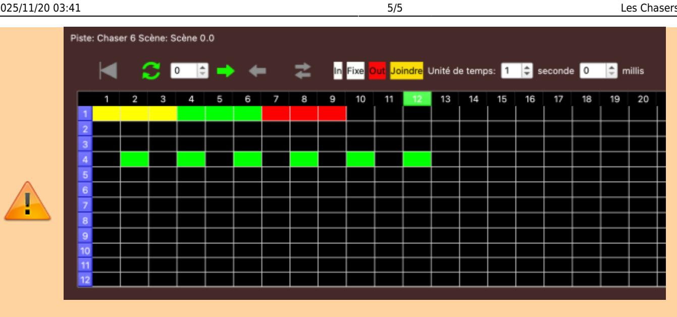
Ex: Dans l'exemple ci-dessus, sans le mode joindre, Hephaestos va faire monter la mémoire 1, 3 fois en 1 seconde. Avec le mode joindre, il va faire une montée de 3s.
